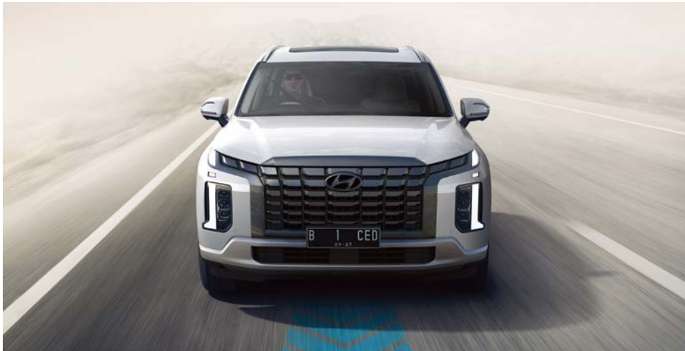
Lane Following Assist (LFA)* Kamera depan melacak penanda garis jalur dan membantu pengemudi untuk tetap menjaga kendaraan aman di tengah jalur.
