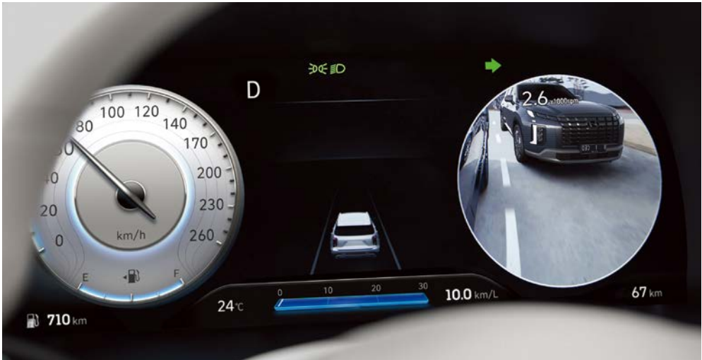
Blind-spot View Monitor (BVM)* Menampilkan titik buta di layar cluster saat lampu sein dinyalakan agar mempermudah pengemudi untuk berpindah jalur
